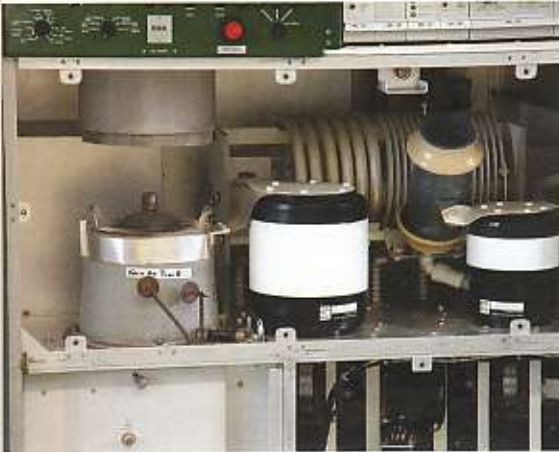
Een Marconi-eindtrap: de rondeszwart/witte objecten zijn de vacuüm c's
